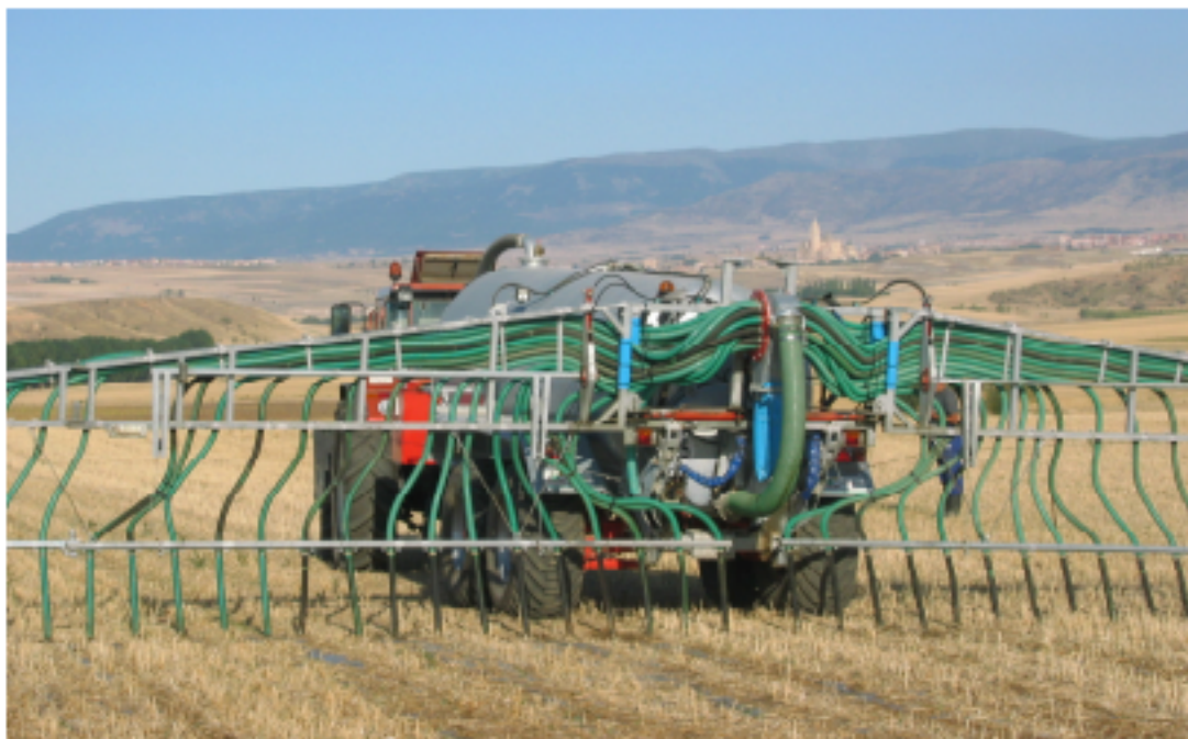
Imagen 10. Sistema de aplicación de purín mediante mangueras
